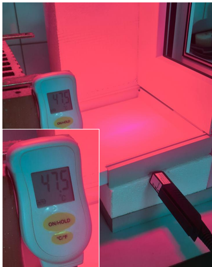
Měření teploty | bílý parapet
