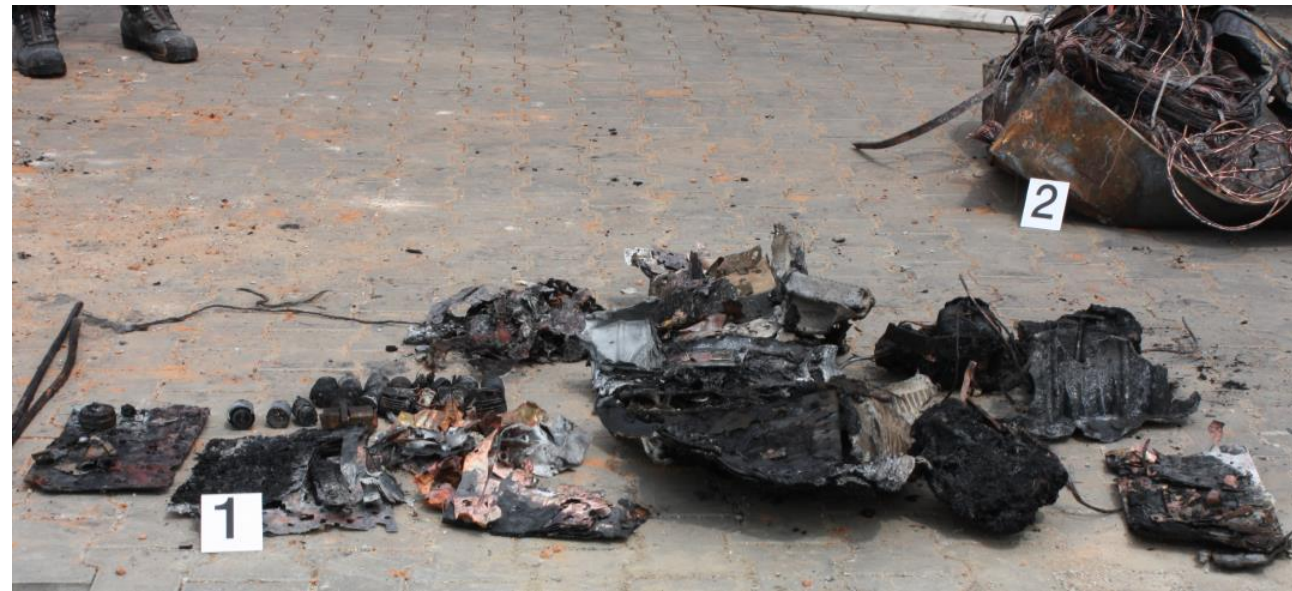
Zajištěné stopy – destruované zbytky měničů a jisticích prvků
