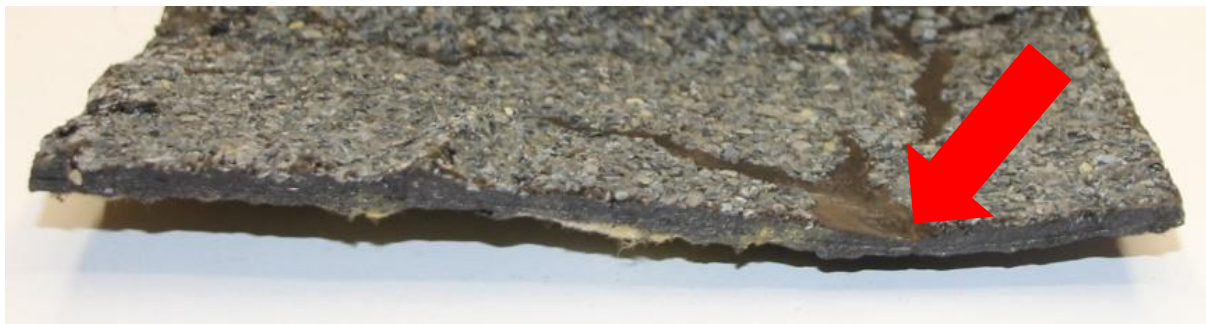
Obr. č. 9 – Řez krokodýlingem asfaltového modifikovaného pásu
