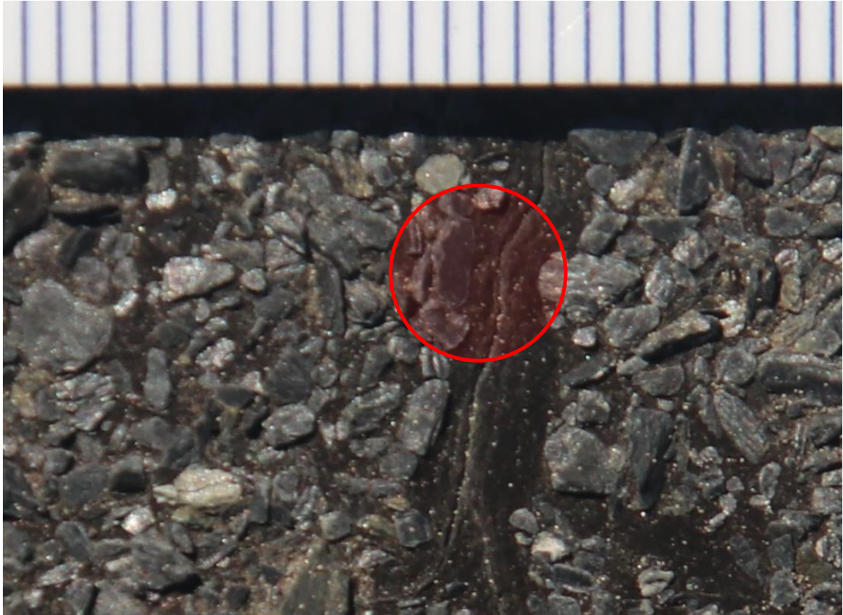
Obr. č. 13 – Detail krokodýlingu – vložený kruh je velikosti 5 mm
